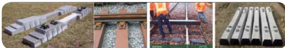
Slika 14. Prikaz različitih vrsta pragova od kompozitnih materijala
