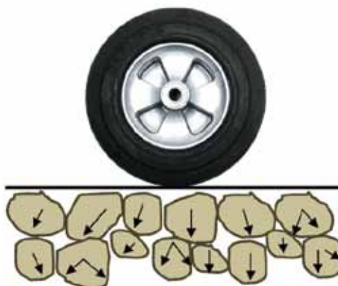
Slika 3. Prenos opterećenja u granularnim strukturama
