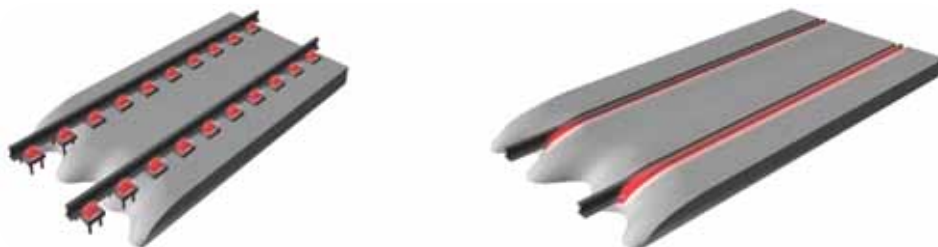
Slika 12. Shematski prikazi monolitnog kolosijeka i kolosijeka sa elastično obloženom šinom
