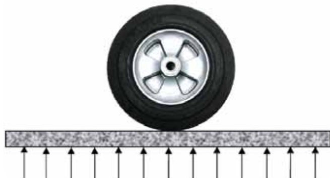
Slika 4. Prenos opterećenja kod krutih kolovoznih konstrukcija
